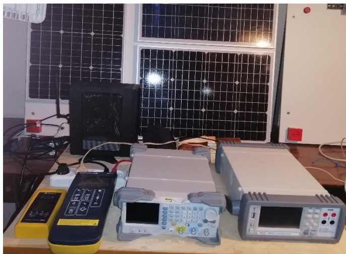
Рисунок 1 – Апаратна частина комплексу визначення технічного стану ФЕС
