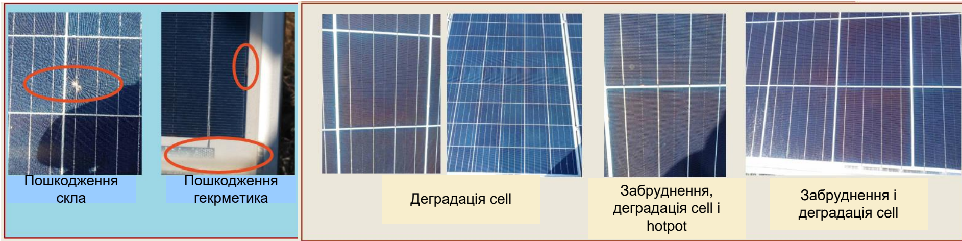
Рисунок 1 – Пошкодження виявлені на ФЕМ шляхом візуального огляду
