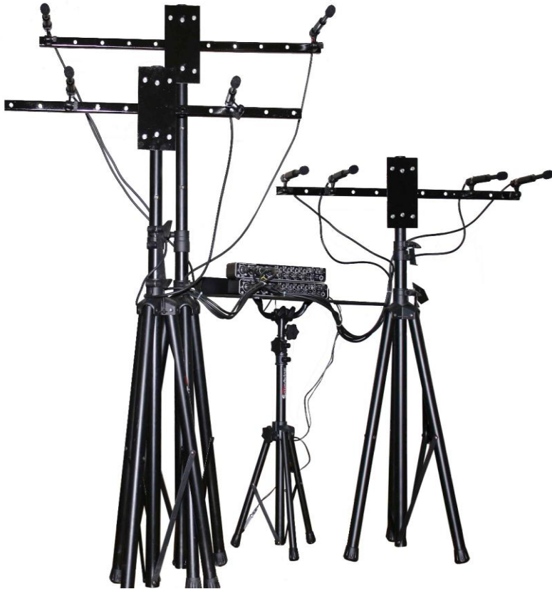
Стійки з мікрофонними решітками 8-канальної 3-променевої АЦ-системи сканування акустичних сигналів на місцевості
