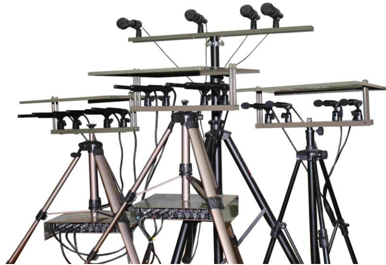
Стійки з мікрофонними решітками 16-канальної 4-променевої АЦ-системи сканування акустичних сигналів на місцевості
