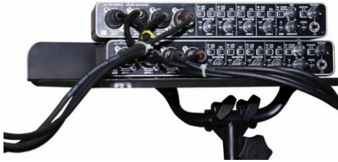
8-канальний варіант входних підсилювачів-перетворювачів на базі аудіоінтерфейсів з Behringer U-Phoria UMC404HD
