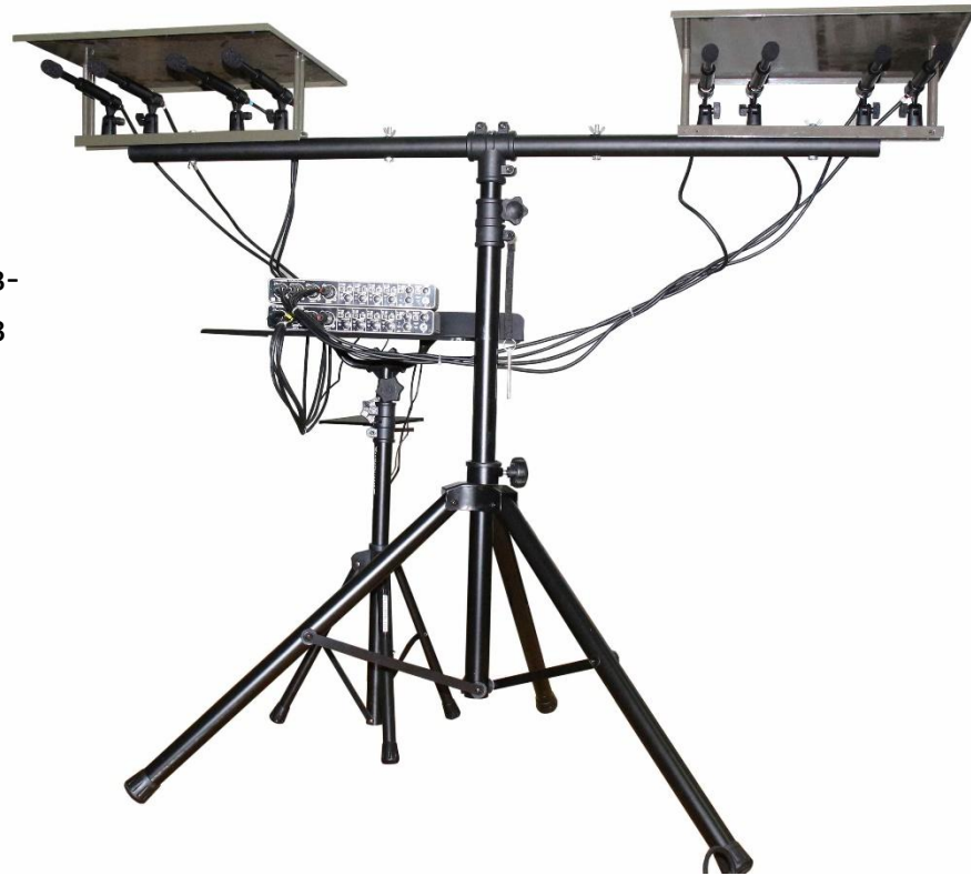
Стійки з мікрофонними решітками 8-канальної 2-променевої АЦ-системи сканування акустичних сигналів на місцевості
