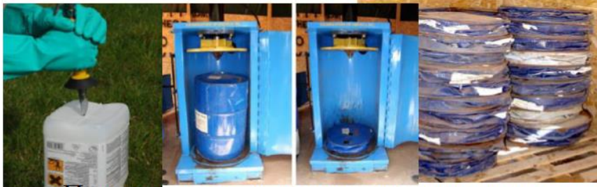
Процеси проколу, промивання та пресування контейнерів з-під пестицидів
