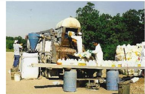
Процес подрібнення промитої пластикової тари з пестицидів у мобільному шредері
